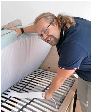
«Man bemerkt die Geräte gar nicht gross»: Andreas Dreier von der SAW zeigt einen Sensor, der unter einer Bettmatraze liegt und den Schlaf überwacht.
